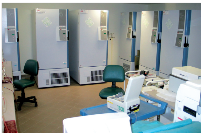
Obr. 3. Mechanické hlubokomrazicí boxy (na min -80^{\circ}\text{C} ).
