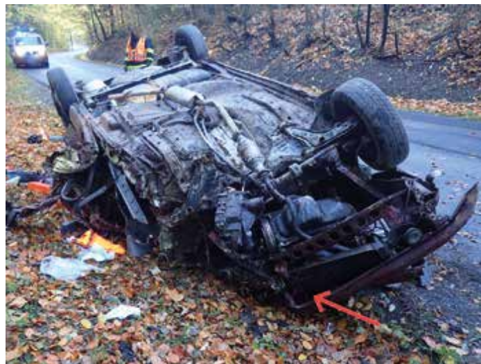
Obr. 8. Ukázka deformace exteriéru vozidla č. 2. Fig. 8. Illustration of the vehicle no. 2 exterior deformation.
