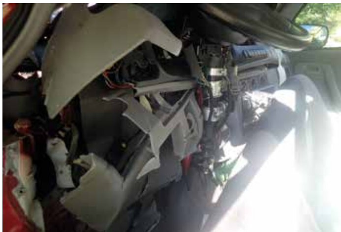
Obr. 4. Ukázka deformace interiéru vozidla č. 1.
