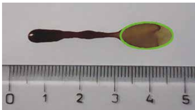
Obř. 2. Metoda ellipse fitting. Modelový stříkanec (instantní káva, volný pád 10 cm, úhel dopadu 45°, kancelářský papír) byl vyfotografován. V programu ImageJ (ver 1.50.i) bylo označeno deset bodů, které by měly tvořit elipsu, ta pak byla vytvořena funkcí Fit Ellipse. Její poloosy W=7,7 mm a L=15,7 mm, tedy odhadnutý úhel dopadu je 30°. Ke zvýraznění elipsy obraz upraven v programu Gimp (ver. 2.8.16).
