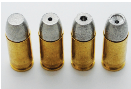
Obr. 4. Experimentální české náboje se střelami frangible na bázi železného prášku (dutina zvyšuje pravděpodobnost rozkladu střely).
