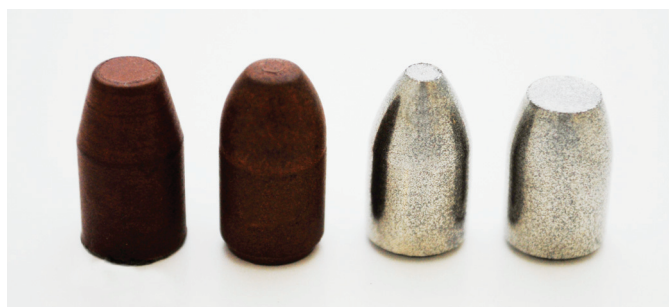
Obr. 1. Různé druhy pistolových střel frangible v ráži 9 mm Luger; zleva 2 střely vyrobené z měděného prášku, vpravo 2 střely vyrobené ze železného prášku.
