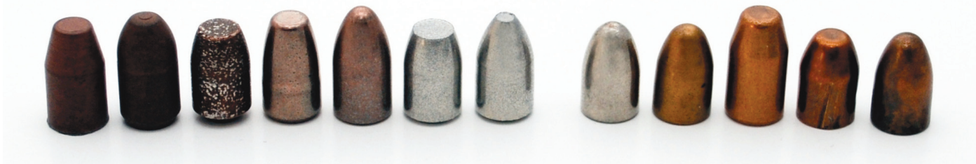
Obr. 2. Srovnání vzhledu střel frangible (vlevo) s klasickými celopláškovými střelami s olověnou výplní (vpravo); zcela vpravo dvě vystřelené střely s drážkami od vývrtu hlavně (všechny střely ráže 9 mm Luger).
