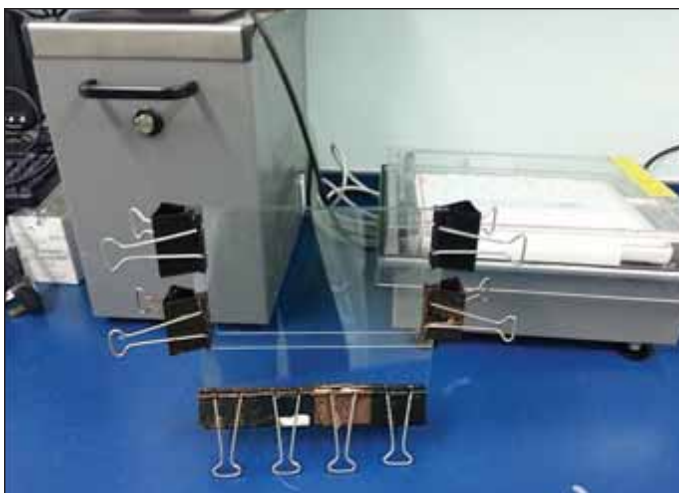
Obr. 2. Elektroforetická zostava pre manuálnu metódu (vlastné údaje).
