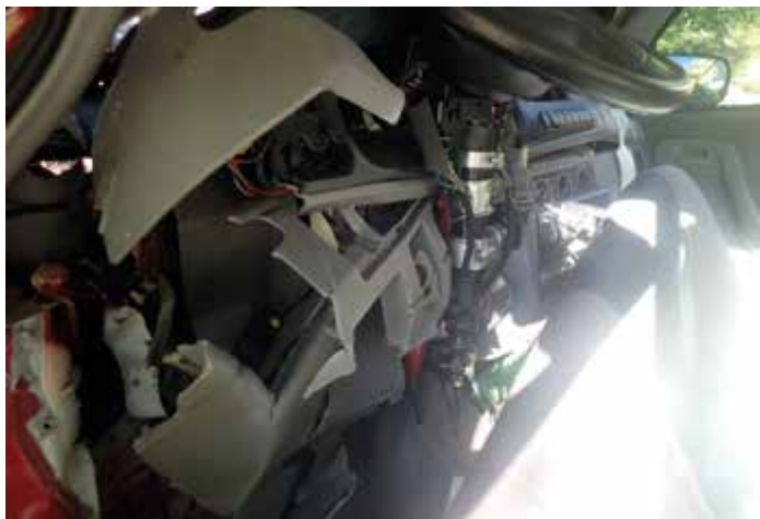
Obr. 4. Ukázka deformace interiéru vozidla č. 1.
