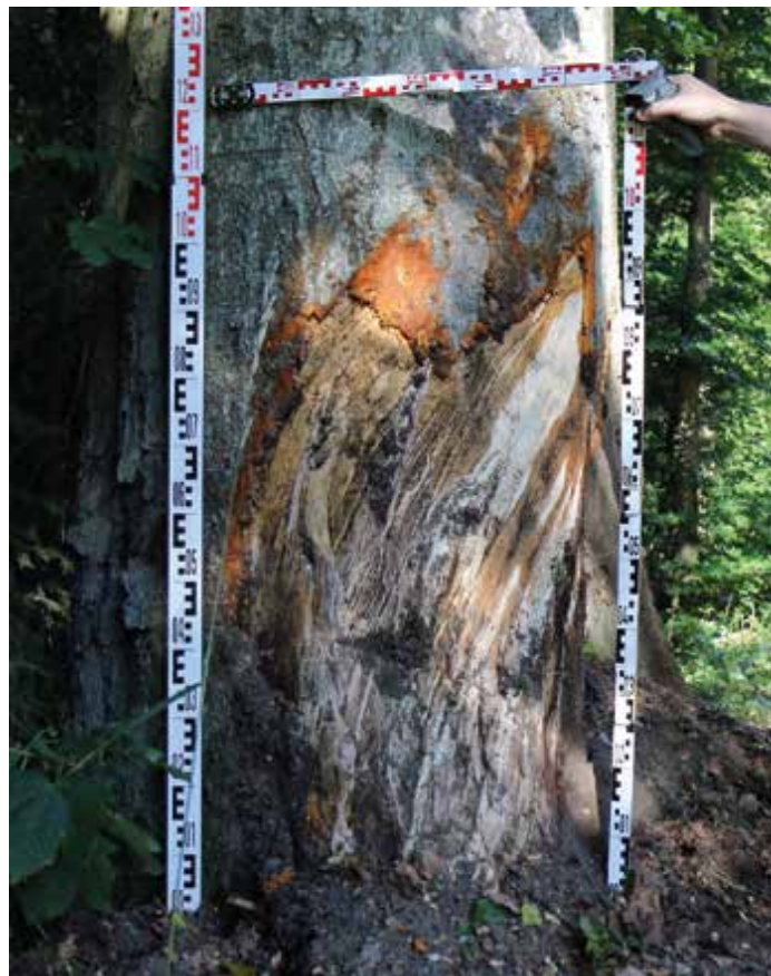
Obr. 2. Stopy po kontaktu s vozidlem č. 1 zanechané na stromě.
