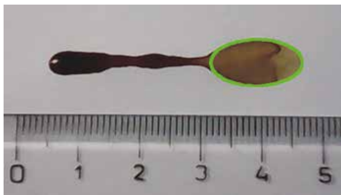
Obr. 2. Metoda ellipse fitting. Modelový stříkanec (instantní káva, volný pád 10 cm, úhel dopadu 45°, kancelářský papír) byl vyfotografován. V programu ImageJ (ver 1.50.i) bylo označeno deset bodů, které by měly tvořit elipsu, ta pak byla vytvořena funkcí Fit Ellipse. Její poloosy W=7,7 mm a L=15,7 mm, tedy odhadnutý úhel dopadu je 30°. Ke zvýraznění elipsy obraz upraven v programu Gimp (ver. 2.8.16).
