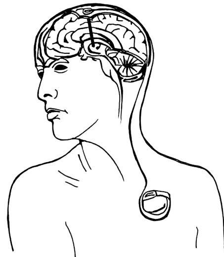
Obr. 5. Schéma implantovaného stimulačního systému (elektroda, spojovací kablík, neurostimulátor)
